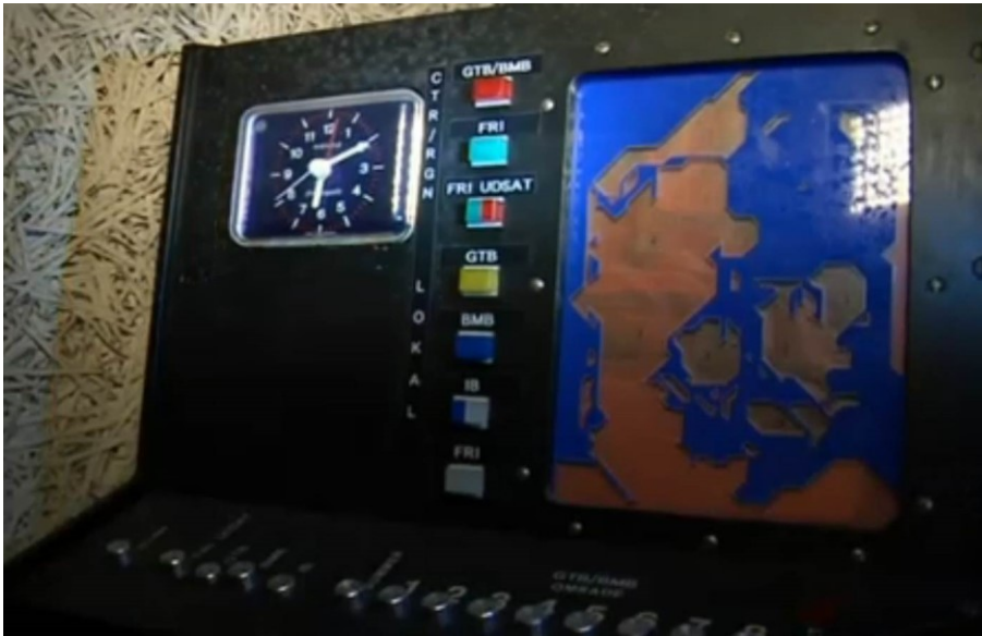
Dette apparat blev brugt til at markere hvilke områder, der var blevet udsat for bombeangreb, gas osv. Der er ikke set lignende apparater andre steder hvorfor der muligvis er tale om en prototype, som ikke kom i anvendelse. Foto: TV2 ØST 3/1 2013.
